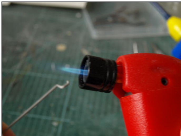
Mit einem Lötgerät können die Fallrohre vorsichtig erwärmt und dann angepaßt werden. Achtung - natürlich nicht zu dicht drangehen!
